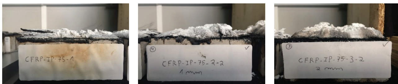
Figura 20 Provetes reforçados com manta de CFRP e protegidos com tinta intumescente, submetidos ao fluxo de calor de 75 kW/m 2
