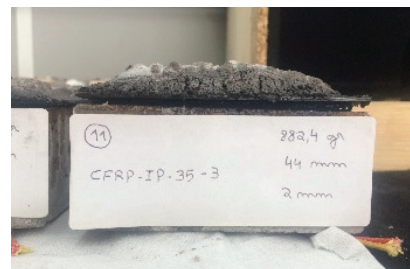
Figura 19 Provetes reforçados com laminado de CFRP e protegidos com tinta intumescente, submetidos ao fluxo de calor de 35 kW/m 2
