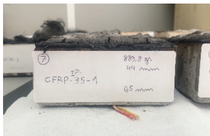
Figura 19 Provetes reforçados com laminado de CFRP e protegidos com tinta intumescente, submetidos ao fluxo de calor de 35 kW/m 2
