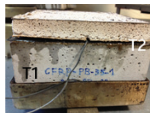
Figura 6 Provetes protegidos com placa de gesso
