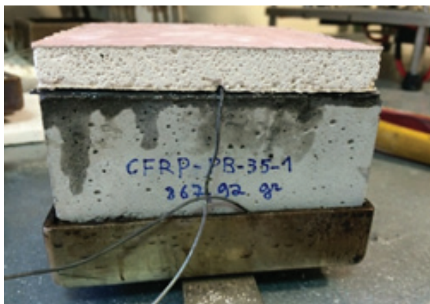
Figura 3 Provetes protegidos com placa de gesso
