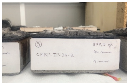
Figura 19 Provetes reforçados com laminado de CFRP e protegidos com tinta intumescente, submetidos ao fluxo de calor de 35 kW/m 2
