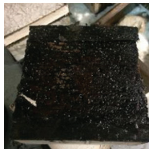
Figura 16 Provete reforçado com mantas de CFRP, e protegido com placa de gesso, sujeito ao fluxo de calor de 75 kW/m 2
