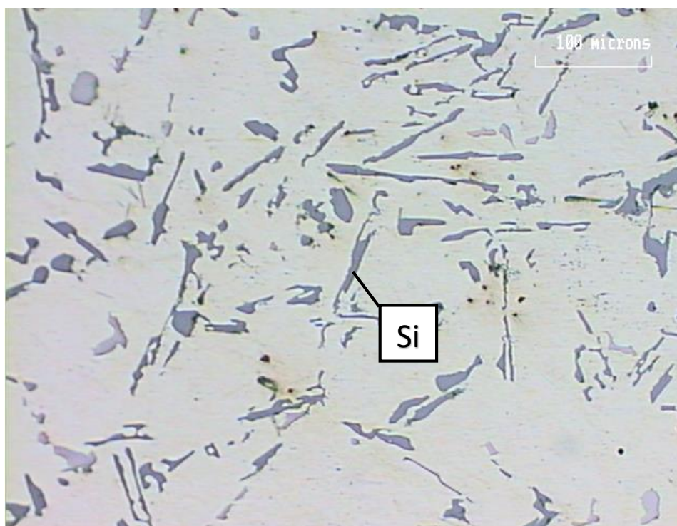
Figura 4.14. Colada 10 x200, després del tremp
