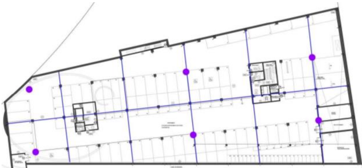
Fig. 7. Ejemplo de sensorización de intensidad media en el edificio Neapolis. Las líneas azules muestran la situación de la fibra óptica (en forjados y pilares), los puntos violetas indican la situación de los sensores en la fibra.
