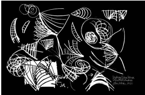
Figura 5: Jørn Utzon. Croquis del estudio de la solución estructural de la cubierta de la Ópera de Sidney, 1956-1963 [Zodiac 10, 1962]
