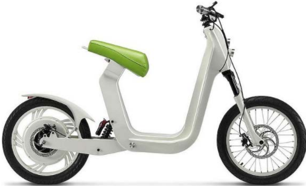
Imatge2.1.- Ciclomotor elèctric monoplaça Xkuty 1500W, 48 V. Autonomia de 50 km i un pes de 45kg
