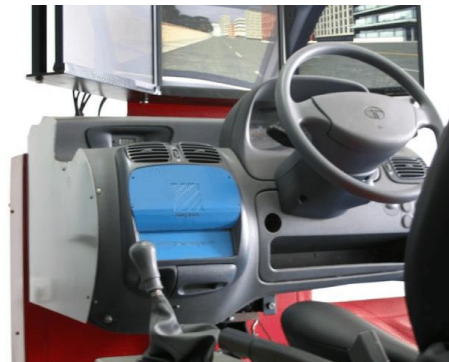
Fig. 9 - Simulación de conducción de un camión
