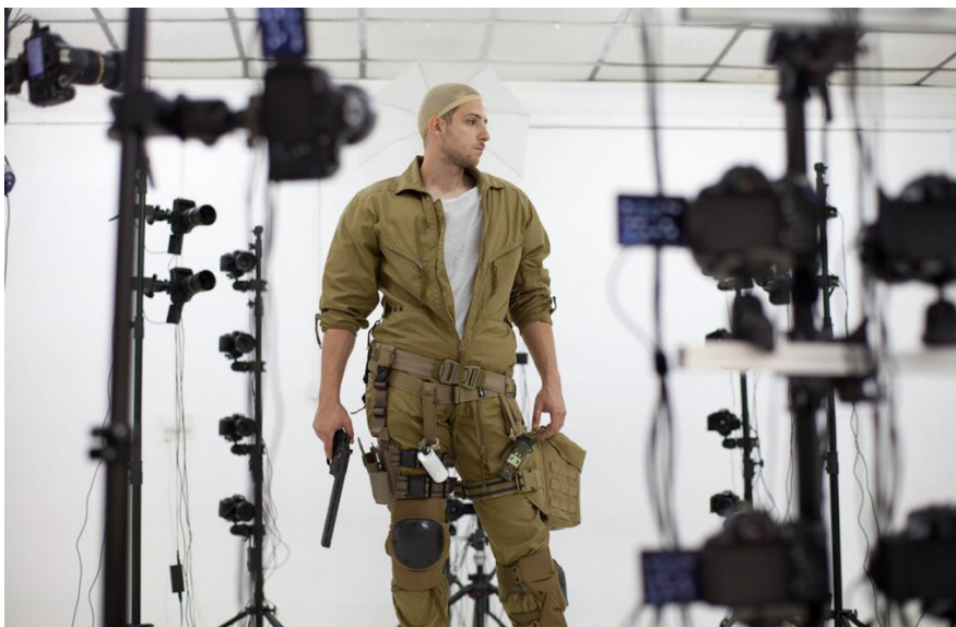
Fig. 24 - Fotogrametría a modo de escaneo 3D
