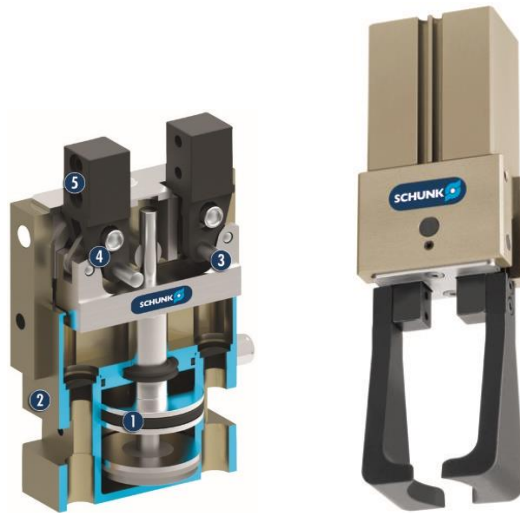
Fig. 2.13. Exemple de l'estructura i funcionament d'un pinça angular, i la pinça angular GAP de SCHUNK.
