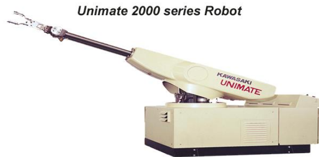
Fig. 2.7. Robot Polar Unimate de Kawasaki.
