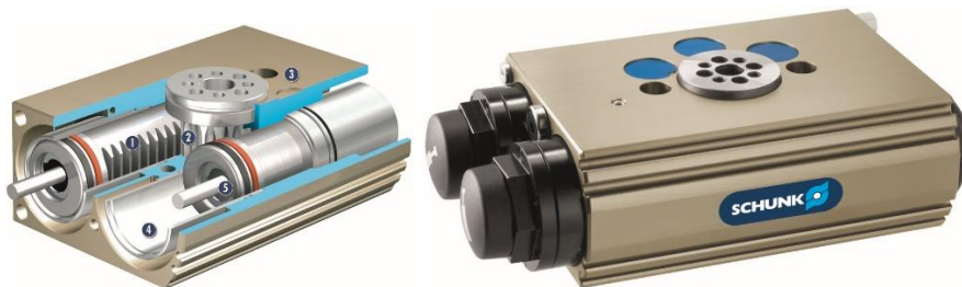
Fig. 2.27. Exemple de l'estructura i funcionament del gir SRU plus de SCHUNK.
