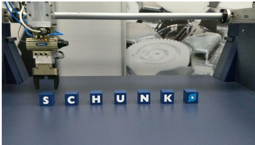
Fig. 0.1. Aplicació a programar amb els cubs i les unitats pneumàtiques.
