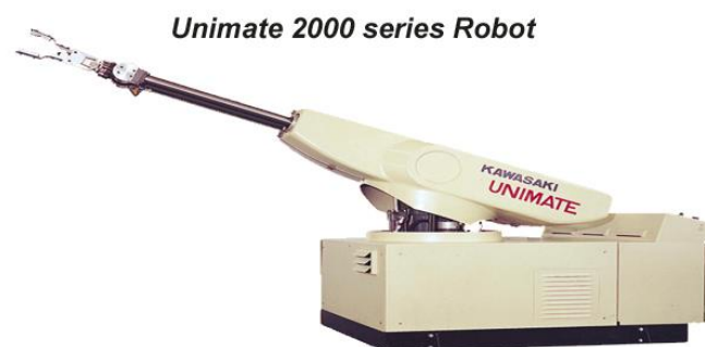
Fig. 2.7. Robot Polar Unimate de Kawasaki.
