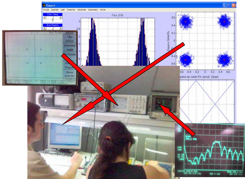
Figura 8. Experimentación instrumental, simulación y verificación teórica de una modulación QPSK en la asignatura de laboratorio de comunicaciones 1. ETSETB. UPC.
