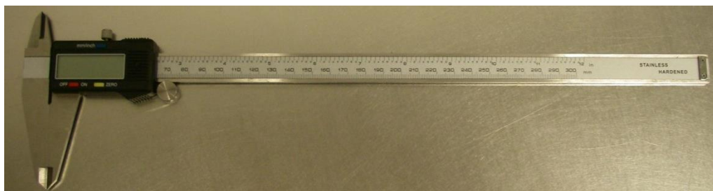
Figura 12: Peu de Rei, instrument per mesurar el col·lapse de l'envàs, calibrat amb resoluci3n 0,01 cm.
