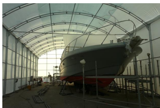
Figura 4. Cabina de pintura. - Font: Marine Equipment
