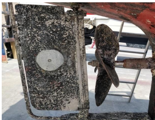
Figura 28. Ànode de sacrifici pala del timó. -Font: pròpia
