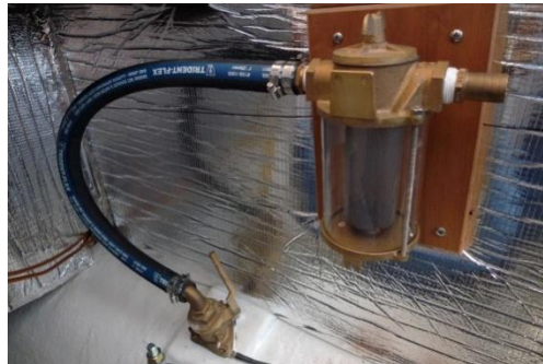
Figura 33. Filtre d'aigua y aixeta de fons. –Font: Blog de Xavier Vila Baiget
