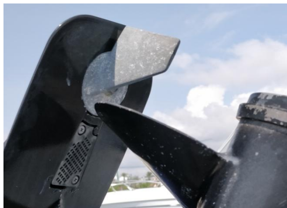
Figura 29. Ànode de sacrifici cua motor foraborda. - Font: pròpia
