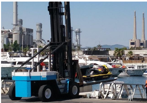
Figura 66. Carretó de varada per embarcacions menors. – Font: pròpia
