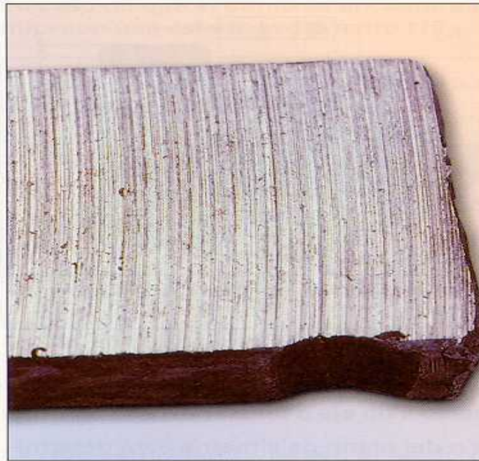
Rugosidad superficial en una pieza cortada con sierra mecánica y en una mecanizada con fresadora
