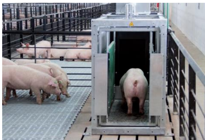
Figura 26. Sistema d'alimentació per identificació electrònica.
