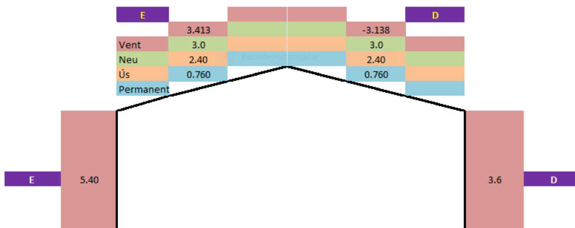
Figura 4. Transmissió d'accions al pòrtic
