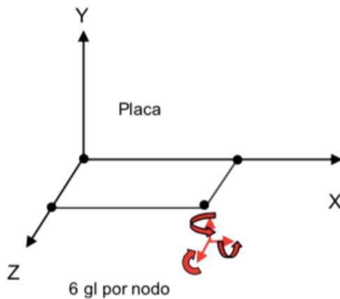
Figura 28: Esquema d'un element tipus Shell[10]
