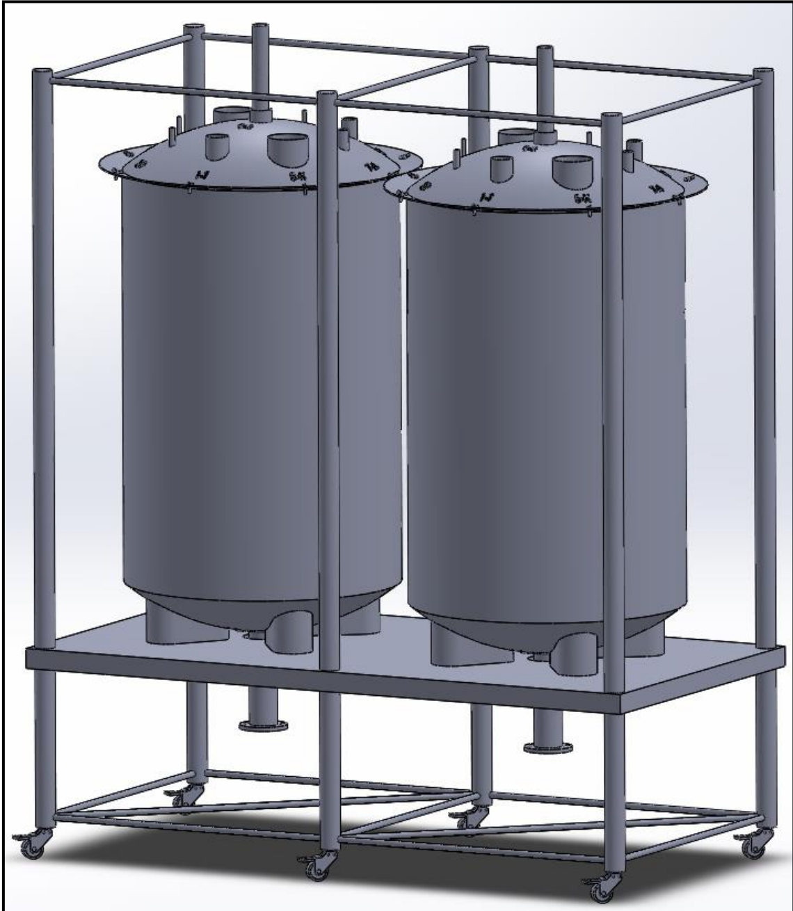
Il·lustració 62. Conjunt estructural amb els dos bioreactors treballant en paral·lel
