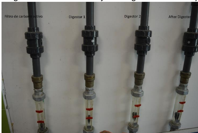
il·lustració 19 Caudals d'aire , cap als digestors
