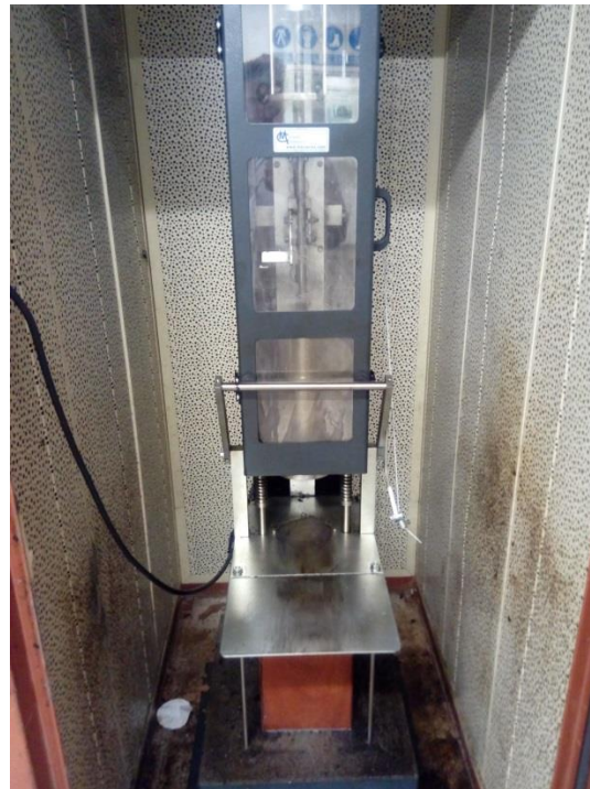
Fig.3.7 Compactador de impactos de la Universidad Politécnica de Cataluña (Elaboración propia, 2017).
