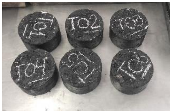
Fig. 3.10 Conjunto de probetas compactadas para ser ensayadas a tracción indirecta (elaboración propia, 2016).
