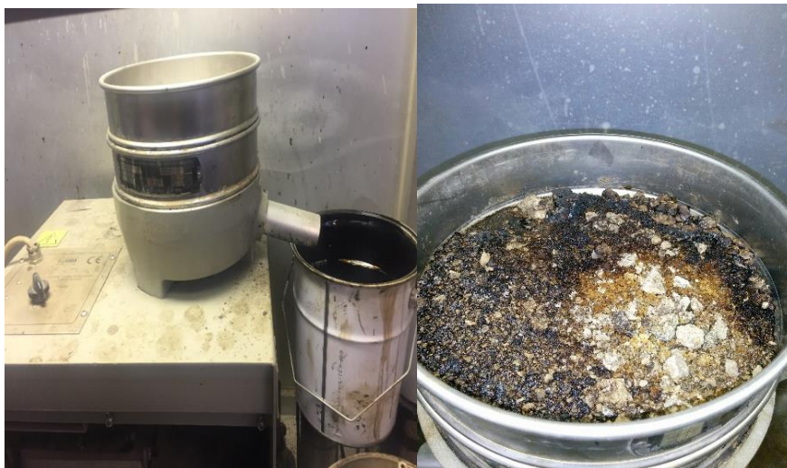
Fig. 3.2 Proceso de extracción del betún del RAP (Elaboración Propia, 2015).
