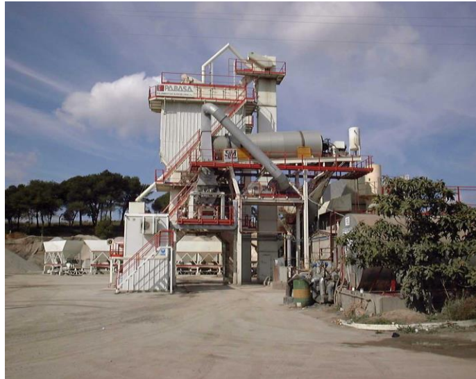
Fig. 2.9 Planta discontinua con doble tambor secador para calentamiento del RAP, (Fuente: www.pabasa.com , 2004).
