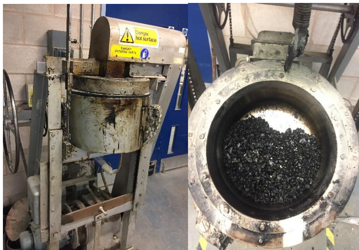
Fig. 3.14 Mezcladora mecánica de la Universidad de Nottingham (Elaboración propia, 2017).
