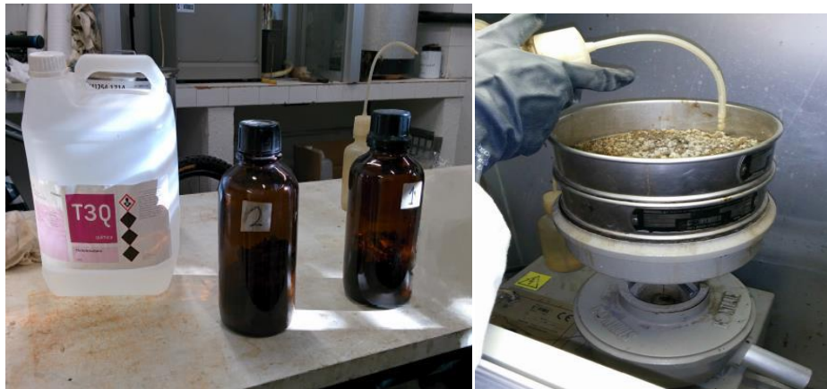
Fig. 3.17 Extracción del Betún del RAP (Elaboración propia, 2015).
