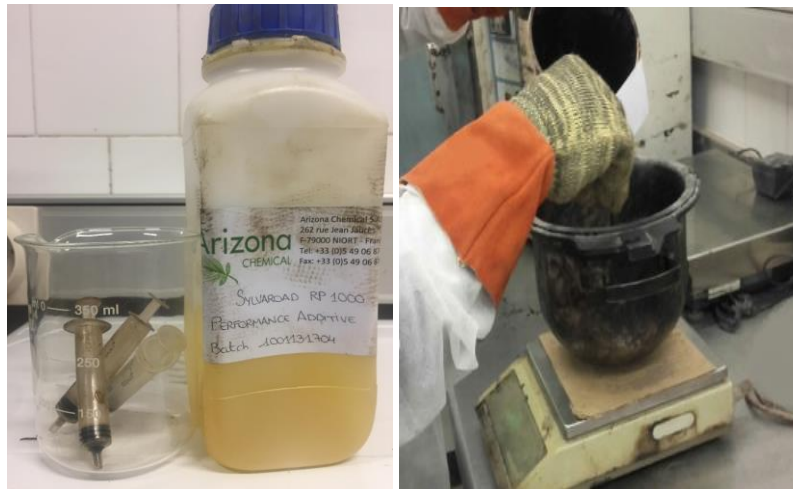
Fig. 3.16 Rejuvenecedor SYLVAROAD™ RP1000 de Arizona BV y aplicación de este sobre el RAP (Elaboración propia, 2017).
