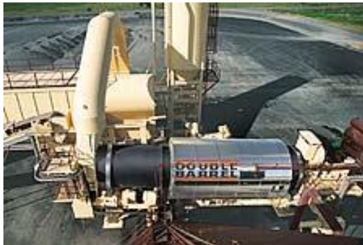
Fig.2.11. Planta continua con tambor secador-mezclador Double Barrel (Fuente: ASTEC www.astecinc.com , 2002).
