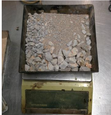
Fig. 3.4 Áridos de aportación de origen calizo (Propia, 2017).
