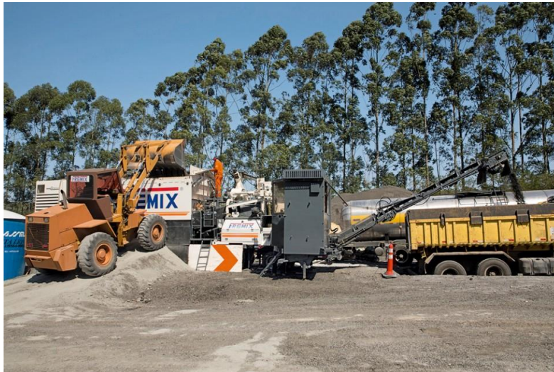
Fig.2.4. Planta de reciclado en frío (Wirtgen Group Technologies, 2010).
