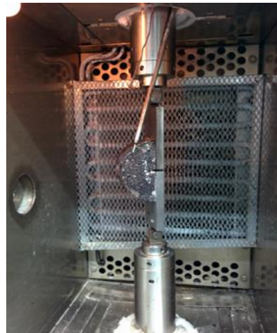
Fig. 3.11 Espécimen sometido al Ensayo Fénix (Pérez-Jiménez, F. et al., 2010).
