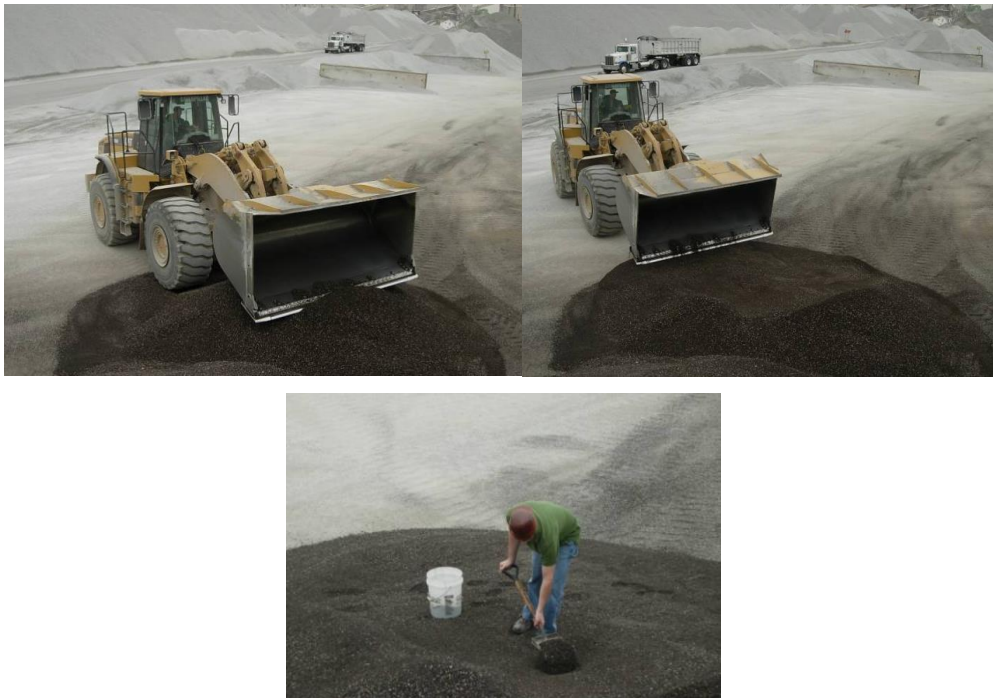
Fig. 2.17 Técnica del “Back-Drugging” y muestreo del RAP para ser caracterizado (Instituto del Asfalto de los Estados Unidos, 2014).
