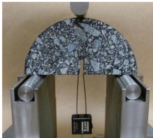
Fig. 2.29. Esquema del ensayo Semi Circular Bending (SCB). (Singh, et al., 2017).
