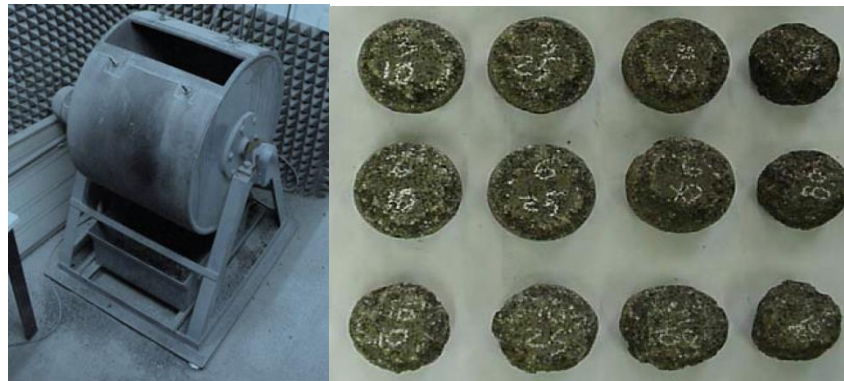
Fig. 3.22 Máquina para el desgaste de los Ángeles y probetas (Elaboración propia, 2017).
