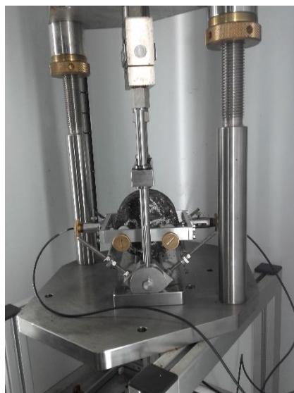
Fig.2.23 Dispositivo para medir el módulo de rigidez por compresión diametral (Cooper Technologies, 2017).
