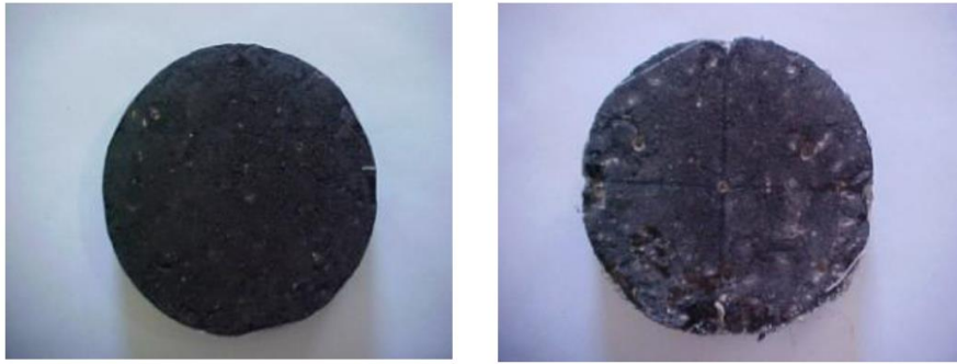
Figura 2.4. Muestras de mezcla bituminosa en caliente antes del envejecimiento (izquierda) y después de 2000 horas de exposición a envejecimiento (derecha) [52].
