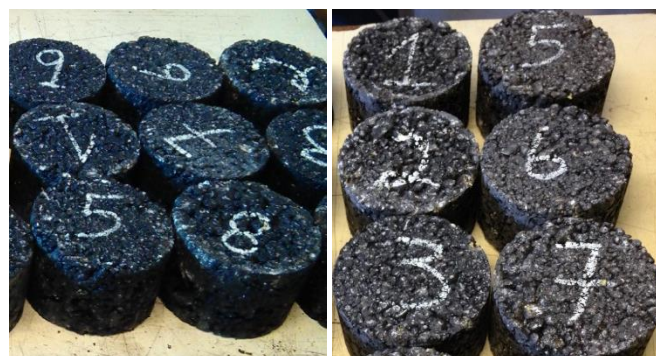
Figura 4.19. Probetas antes y después de someterlas a envejecimiento mediante TEAGE.
