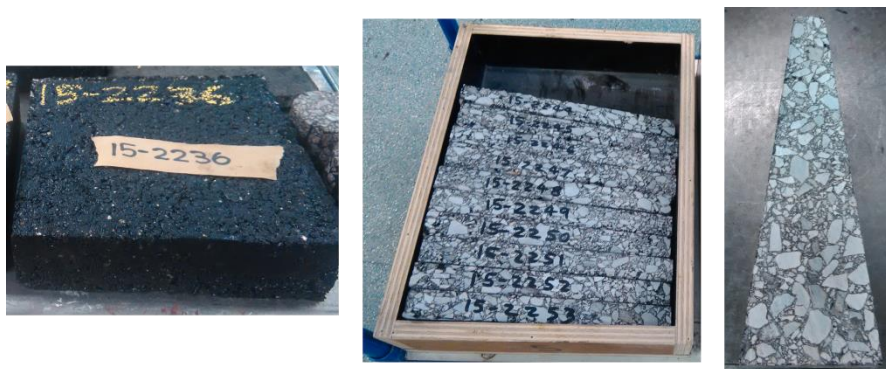
Figura 3.5. De izquierda a derecha, placa de mezcla bituminosa, probetas obtenidas a partir de dicha placa y probeta trapezoidal.
