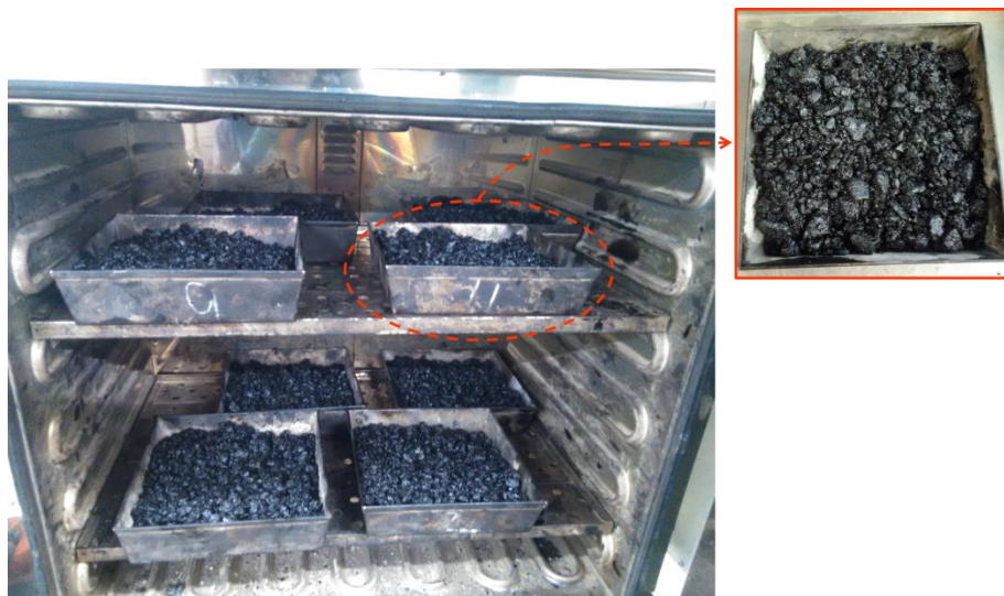
Figura 3.4. Bandejas con la mezcla suelta envejeciéndose en el horno.
