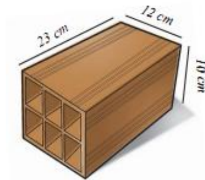
Figura 7: Dimensiones del ladrillo pandereta
