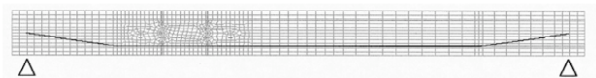
Figura 4. Mallado de la viga V1 incluyendo los elementos tipo cable (en negro).
