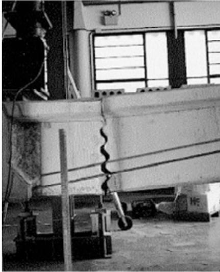
Figura 1. Junta abierta en ELU.
