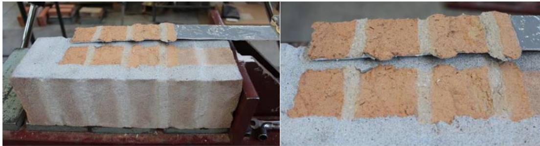
Ilustración 2-15. Delaminación en una viga de hormigón
