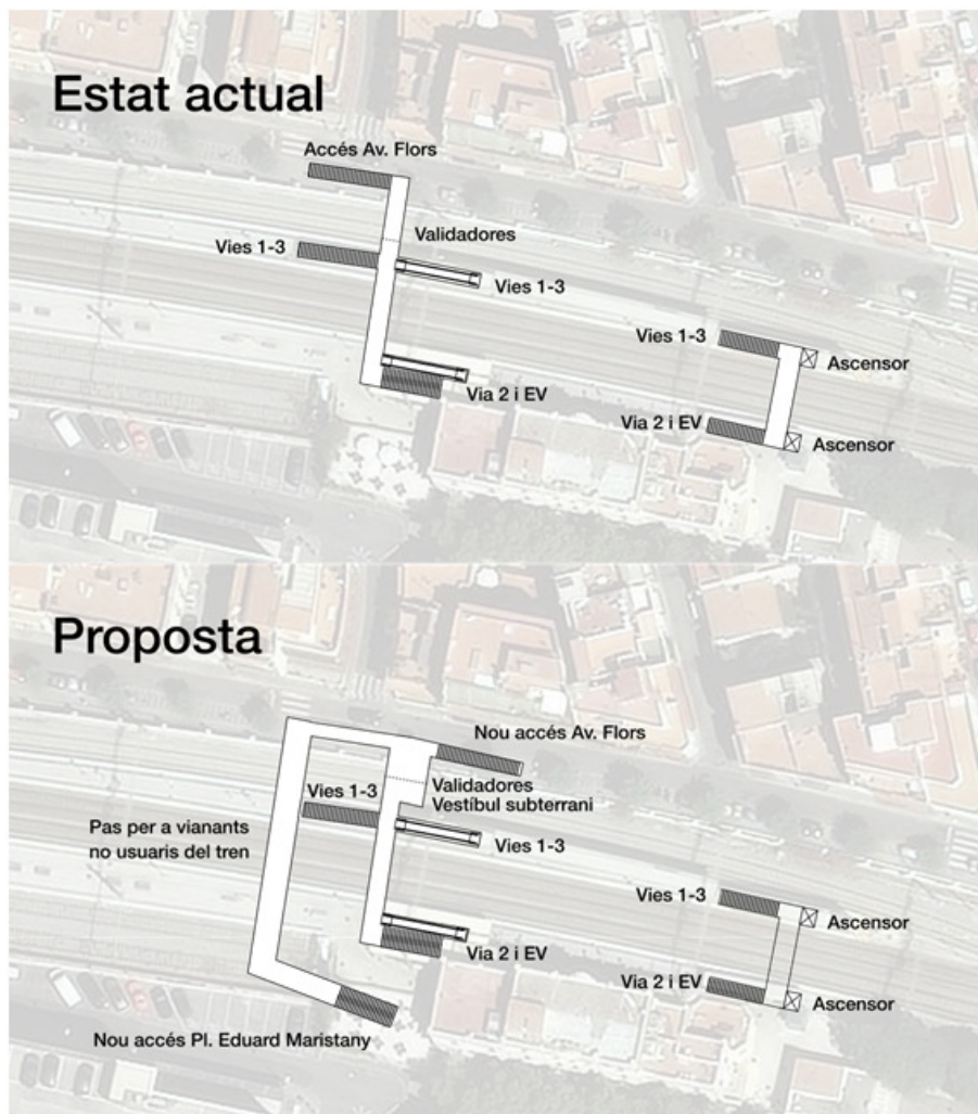
Figura 44: Proposta de modificació dels passos inferiors de l'estació de Sitges. Font: creació pròpia a partir d'ICGC.
