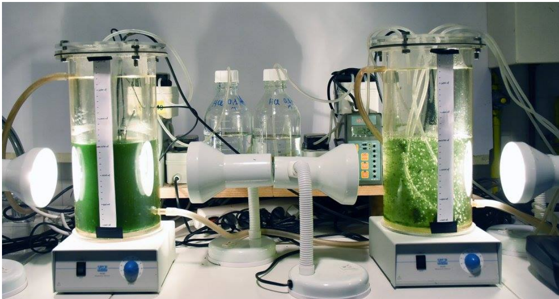
Figura 18: Fotobiorreactores de 3L con camisa de agua y con los pHmetros sumergidos y conectados a las bombas de ácido
