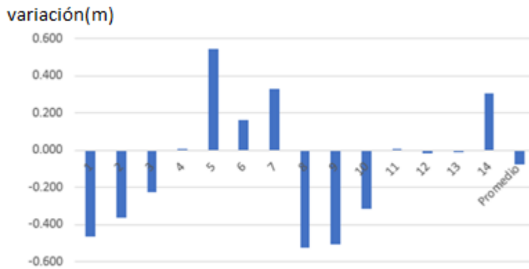
Figura 34: Variación en metros en los puntos de control situados en la carretera
