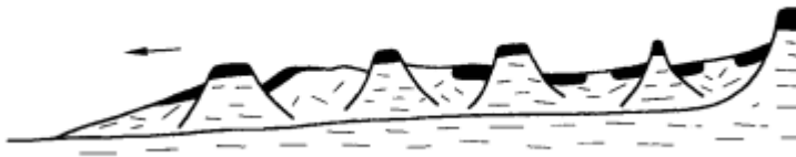
Figura 8: Expansión lateral por licuefacción (Corominas y García Yagúe,1997)
