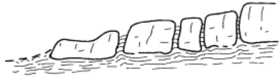
Figura 7: Expansión lateral por extrusión (Corominas y García Yagúe,1997)
