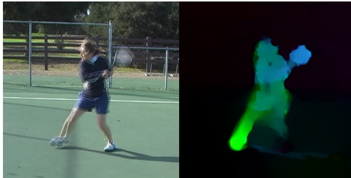
Figura 5: Il·lustració del funcionament d' Optical Flow . Esquerra: Imatges d'un moviment superposades. Dreta: Resultat d' Optical Flow .
