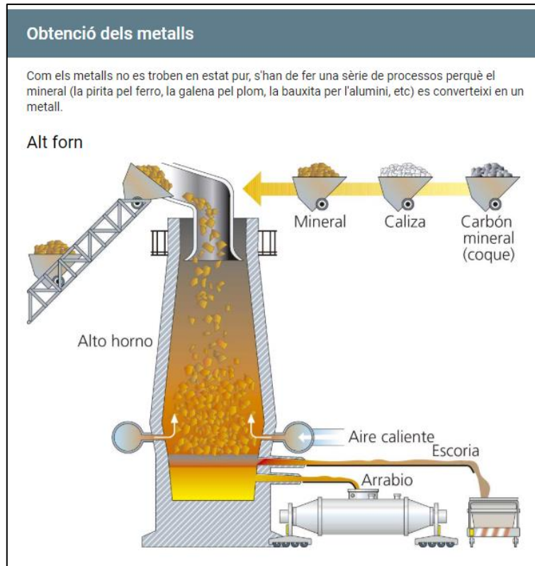
Il·lustració 9. Activitat proposada sobre l'obtenció dels metalls. Esquema d'un alt forn. Font: Wikimedia Commons.
