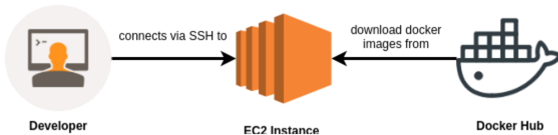
Figura 50: Fase manual del despliegue de los microservicios
