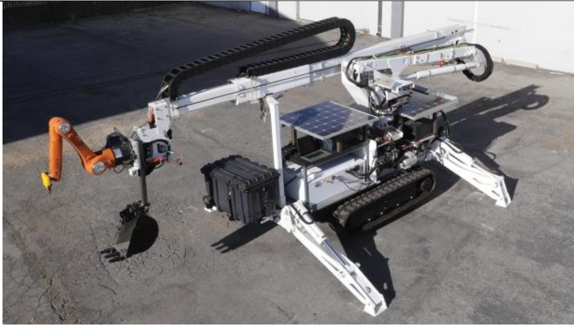
Imatge 4.39. Plataforma del DCP, amb el braç robòtic plegat. S'observa una pala excavadora acoblada per a tasques extremes. Font: website de la CBC News, Technology and Science.
