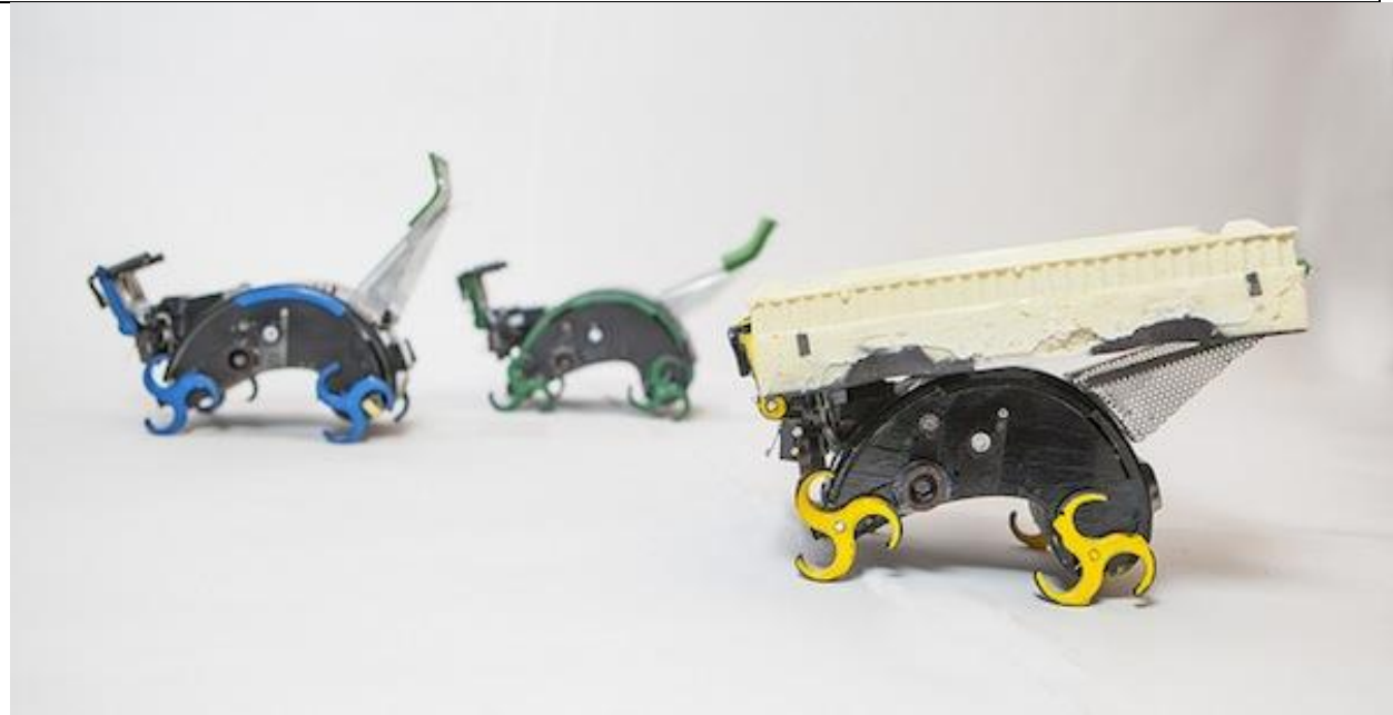
Imatge 4.2. Robots del projecte Termes. El braç fa la tasca de col·locació i manipulació del maons. Font: website de la Science Magazine.
