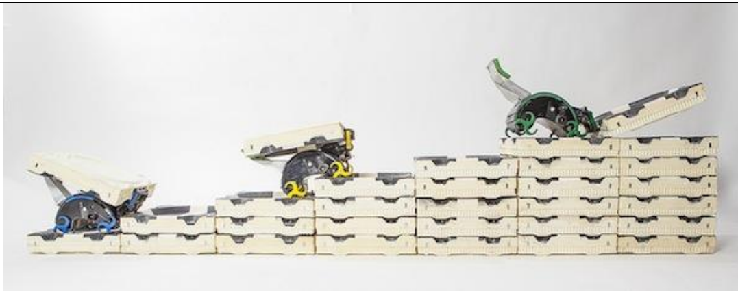
Imatge 4.3. Robots Termes usant l'estructura construïda com escala per a pujar nivells. Font: website de la Science Magazine.
