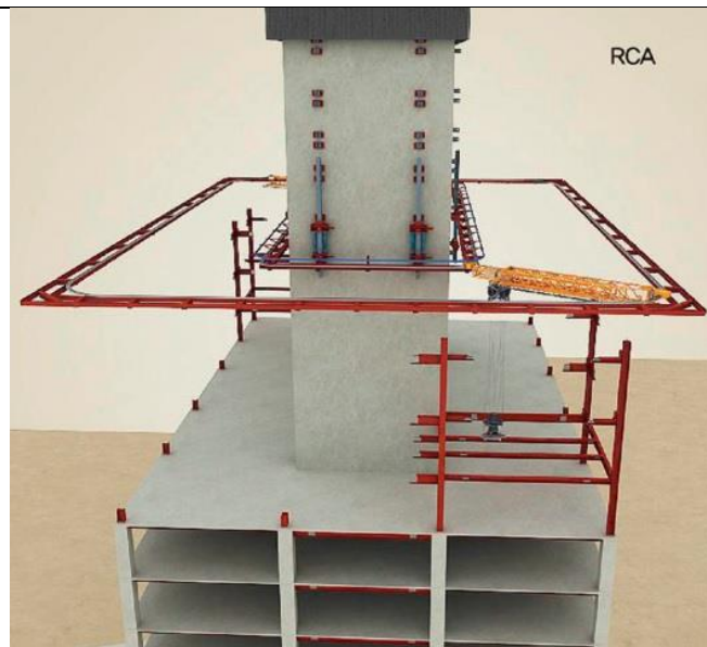
Imatge 4.16. Detall de l'estructura central de formigó i dels rails d'acer per on es desplaça el sistema de transport automatitzat RBA. Font: Google Images..
