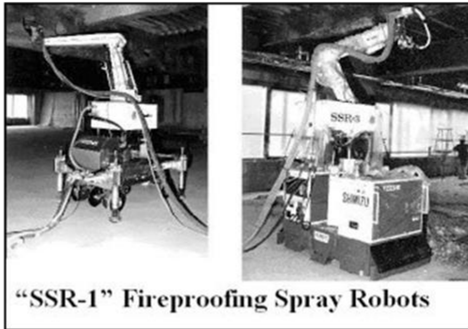
Imatge 2.5. L'SSR-1, del 1983 de Shimizu Corporation. Aquest robot s'ha anat actualitzant i s'usen versions noves en l'actualitat. Font: Construction Robots, The Search for New Building Technology in Japan.
