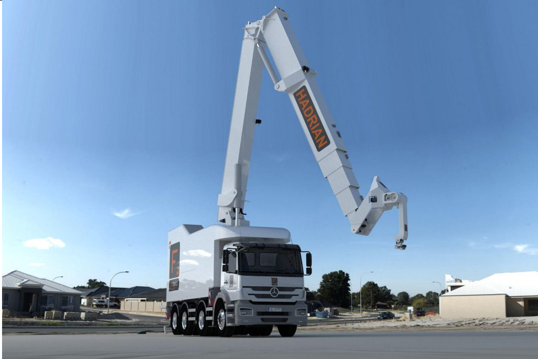
Imatge 4.10. El Hadrian X amb el braç telescòpic llest per començar a executar la construcció. Font: website de Fast Brick Robotics Australia i Google Images.
