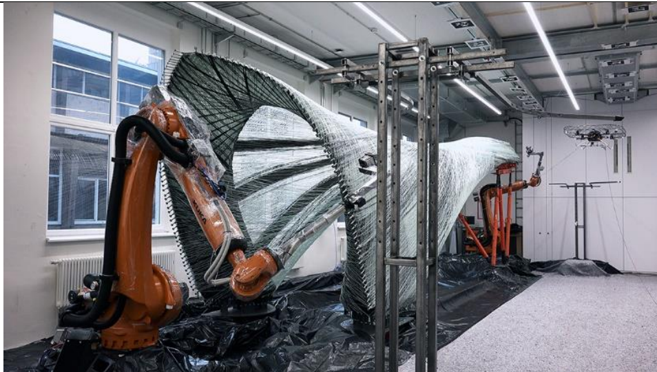
Imatge 4.51. Procés de fabricació del ICD-ITKE Research Pavilion 2016-17. S'observa el dron desplaçant-se d'una de les bandes a l'altre per a transportar la fibra de carboni al braç robòtic. Font: website de ArchDaily.
