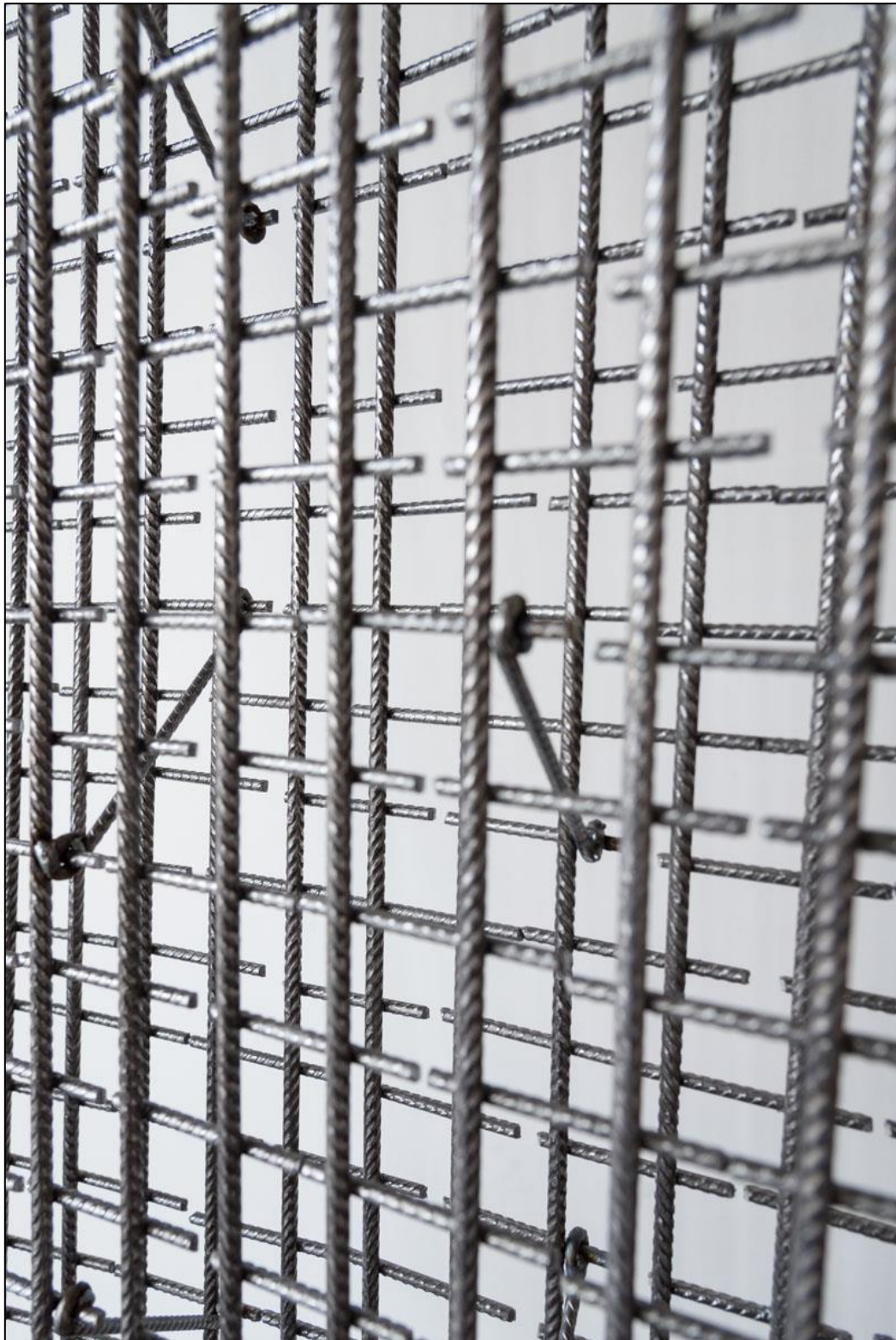
Imatge 4.12. Projecte Mesh Mould Metal. Un braç robòtic col·loca, corba, talla i solda barres d'acer tot fent una malla que fa a la vegada de motlle. Font: website del grup de recerca de Gramazio i Kohler.
