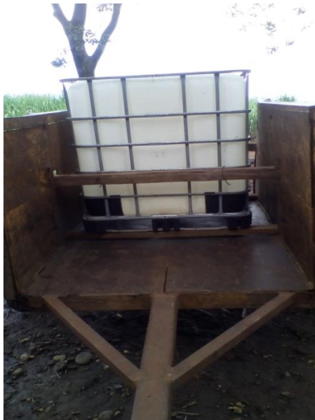
Figura 25. Instalación de tanque de depósito (1,000 L) para agua amoniacal. Fuente: Julian Chun (2017).
