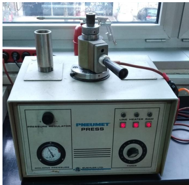
Slika 25. Uređaj za toplo ulijevanje uzorka
