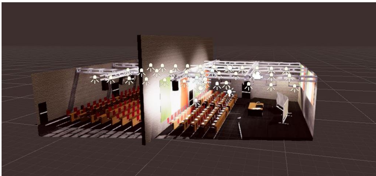
Abbildung 9 Umsetzung der variablen Publikums- und Hörsaalgröße. Hierbei gut zu erkennen die verschiebbare Rückwand des Publikumsbereichs.
