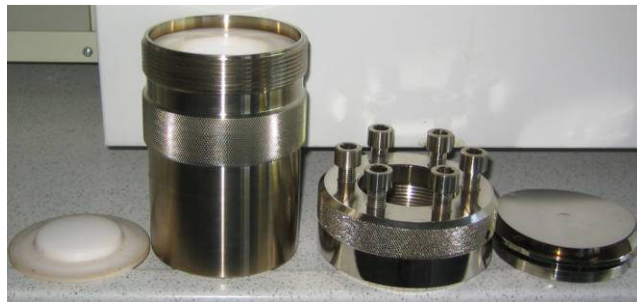
Abb. 9: Für die hydrothermale Umwandlung wurden Säureaufschlussbehälter der Firma Parr verwendet. Das Volumen der Teflonbehälter beträgt 125 ml.
