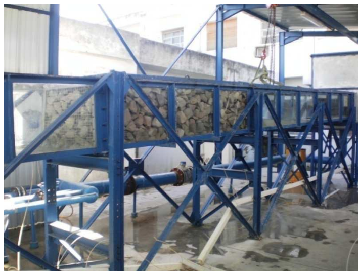
Figure1: Vue du canal construit au laboratoire de l'INAT [7]
