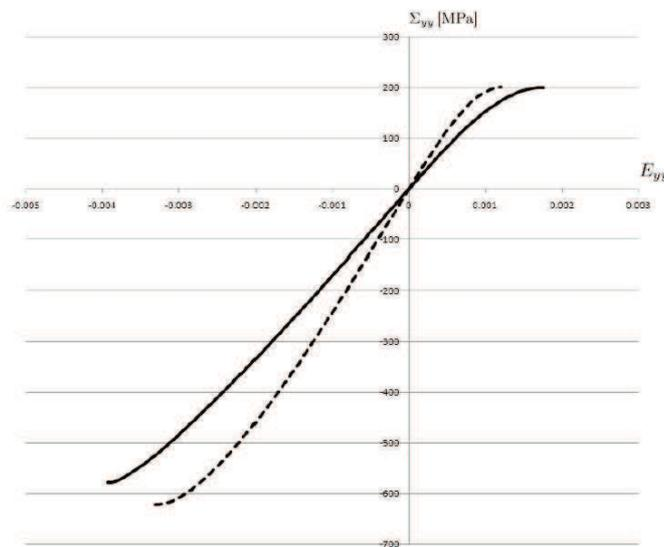
FIG. 2 – Réponse contrainte-déformation axiales du composite SiC-SiC pour des essais de traction et compression uniaxiales d'axe  $\mathbf{y}$  (trait plein :  $\mathbf{y} = \mathbf{e}_2$ , trait pointillé :  $\mathbf{y} = (\mathbf{e}_1 + \mathbf{e}_2)/2$ ).
