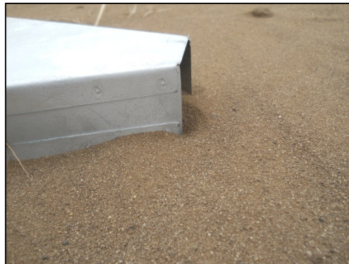
Figure 4. Reduction of transverse profile of device due to soil accumulation Obrázok 4. Zmenšenie profilu deflametra v dôsledku nahromadenia pôdnych častíc
