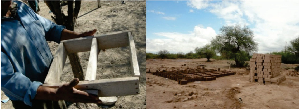
Figura 6. Adoberas utilizadas para la fabricación de los mampuestos bajo la mano de obra familiar y adobes armados secando al sol.
