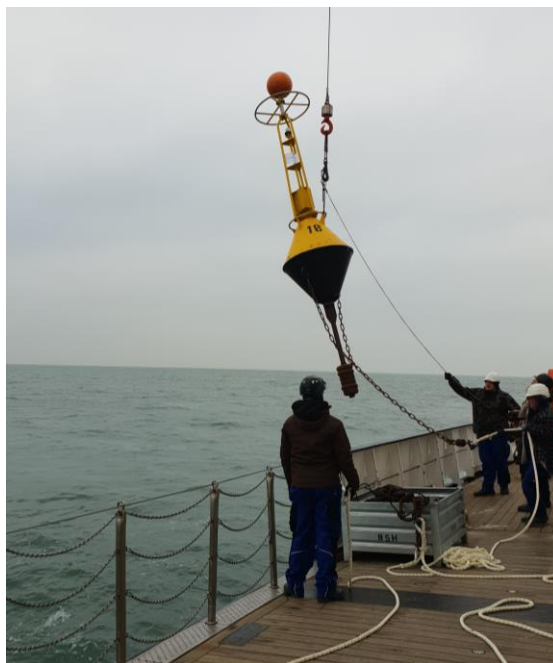
Abb. 1: Aussetzen der Leuchttonne im Arbeitsgebiet am ersten Tag der Ausfahrt.
