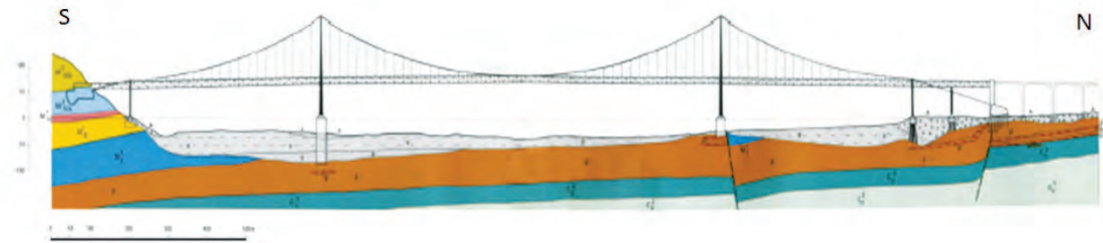
Fig.2 Esquema geológico do Gargalo do Tejo. As falhas assinaladas na margem norte, foram identificadas por reflexão sísmica realizada aquando da construção da ponte 25 de Abril. Extraído de Almeida, 1986 (em Ramos Pereira, 2002).
