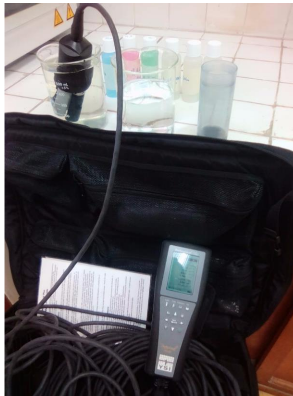
Figura 5-20: Sistema de medición de parámetros fisicoquímicos en muestras de fuentes termales
