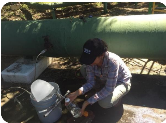
Figura 5-10: Recolección de muestra de vapor condensado de un pozo Geotérmico para análisis de radón ( ^{222}\text{Rn} )
