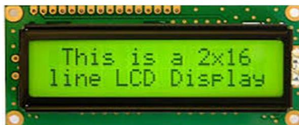
Gambar 8. Modul LCD 16x2
