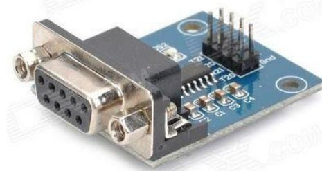
Gambar 6. Konverter RS232 ke TTL
