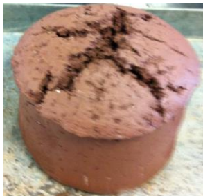
Figura 8. Amostra 2 retirada do corpo de prova após saturação.
