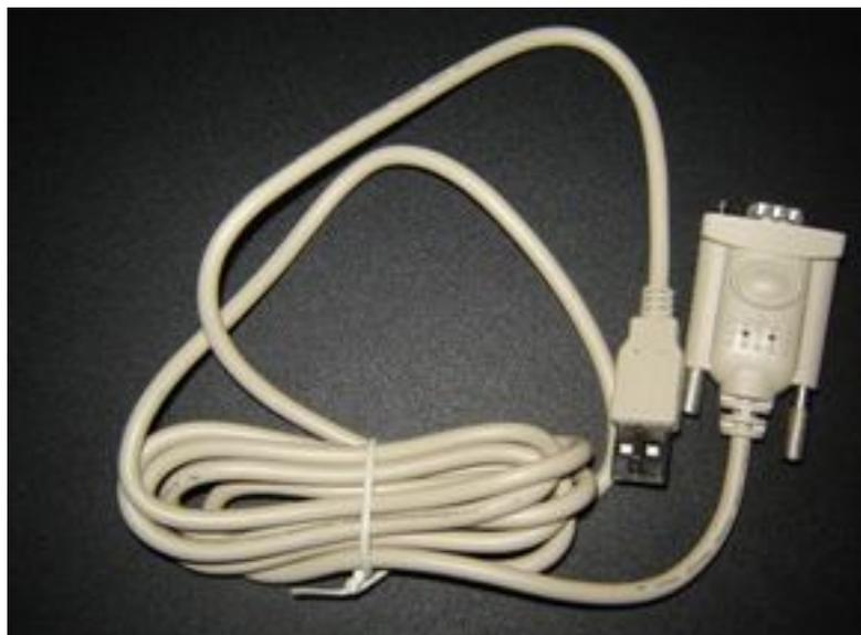
**Figura 5.14- Cabo conversor de interface serial (9 pinos) para USB**
