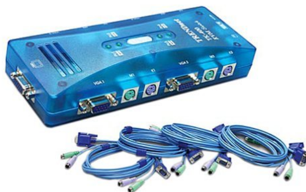
Figura 5–2 Switch KVM TK-400 da TRENDnet
