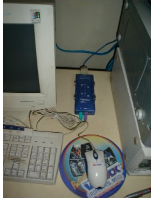
Figura 5-5 KVM com teclado e mouse
