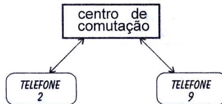
Figura 5: Ligação entre telefones de um mesmo Centro de Comutação. (REIS, 2003).
