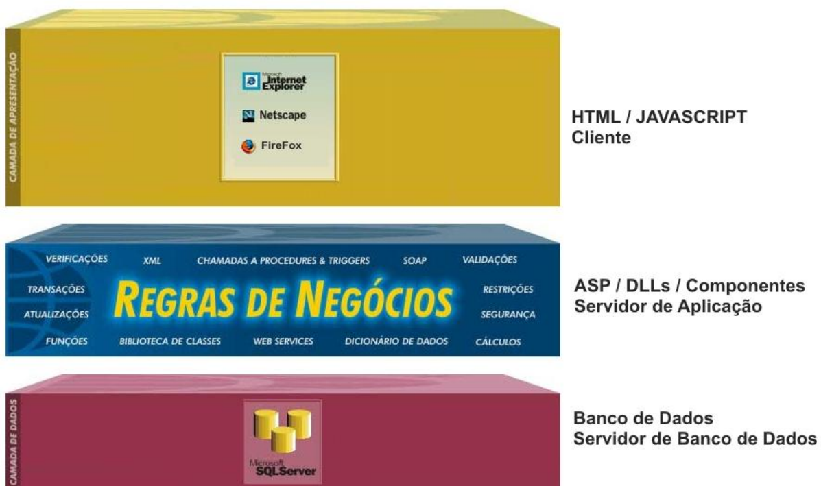
Fig.25 – Diagrama da Arquitetura utilizada no projeto
