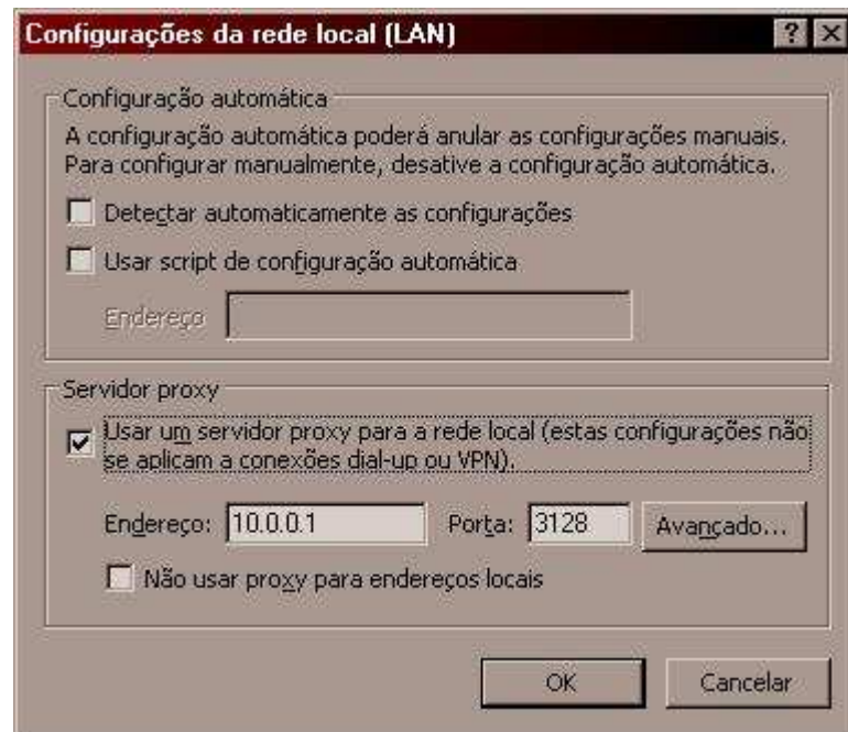
Figura 29: Direcionamento da MAQ_01 para o servidor proxy.
