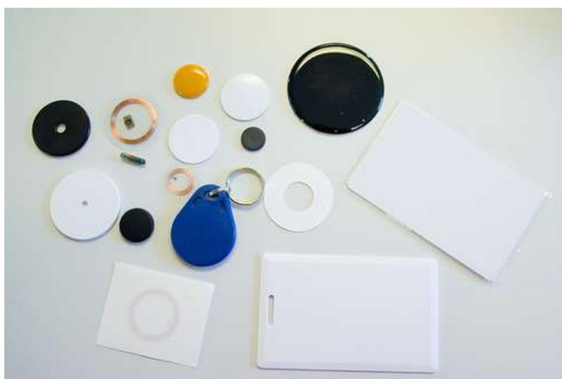
Figura 3.3 – Tipos de etiquetas RFID (RFIDBR, 2011)
