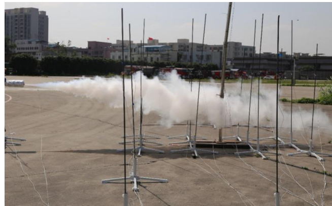
Fig. 2. The flashing LNG jet before ignition.
