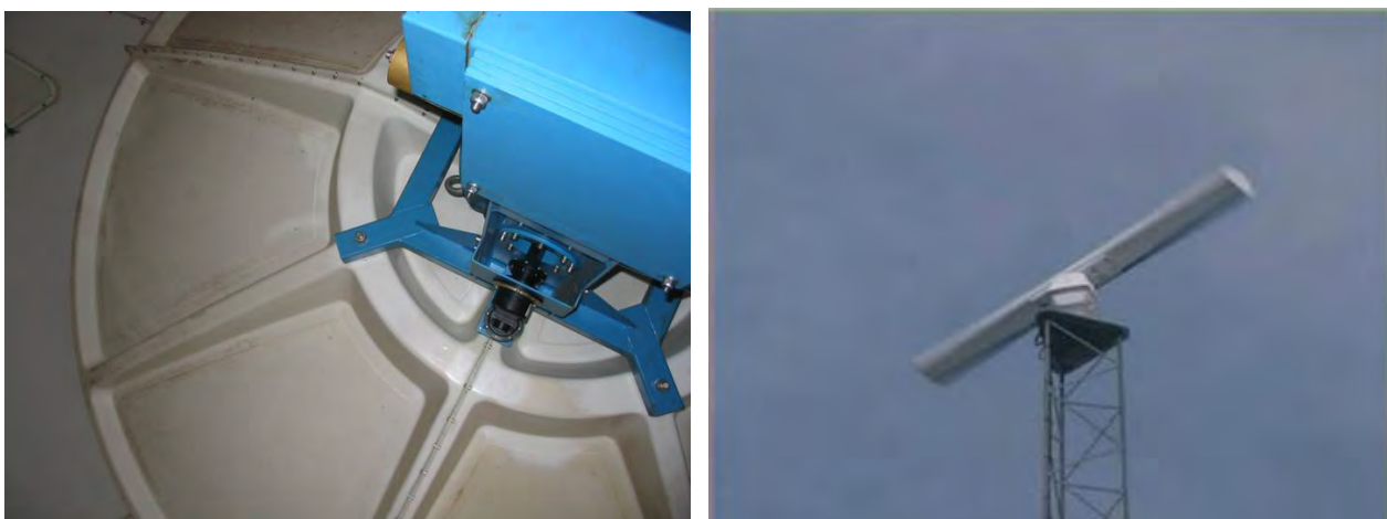
Figur 5.2.c Eksempel på C-båndsradar (Sindal) med parabol antenne og X-båndsradar (Aalborg) med slotted array antenne.
