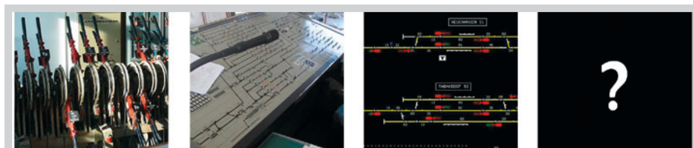
Bild 1: Entwicklungsschritte der Bedienoberfläche des Stellwerks
